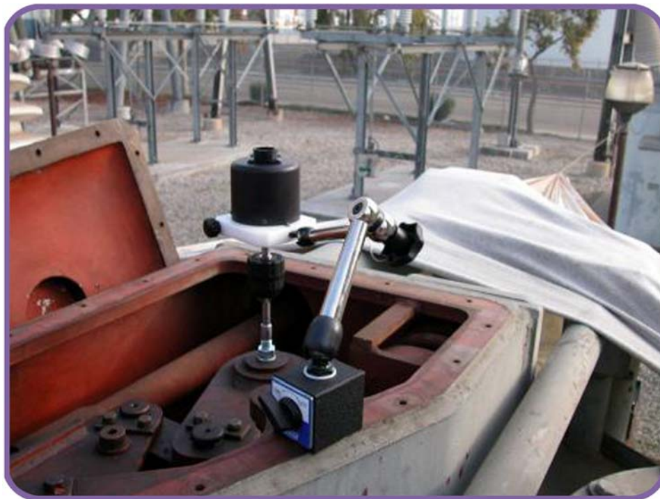
Figura 32. Transductor Rotacional en un interruptor Federal Pacific
